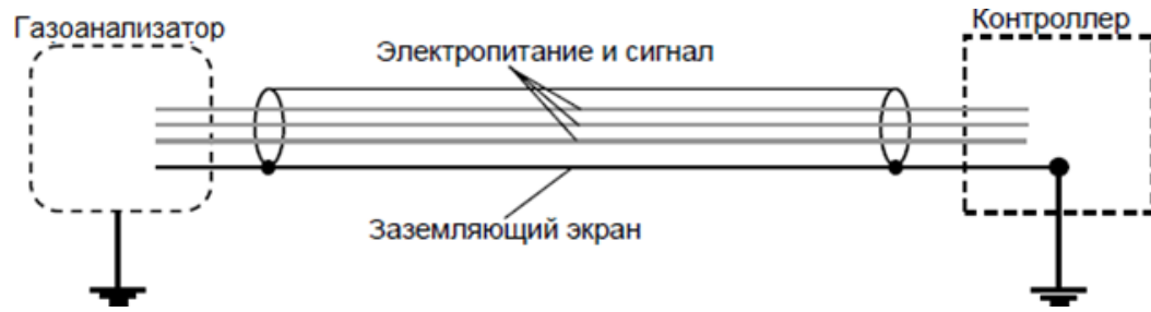
Рисунок 40 – Заземление экранированного кабеля
